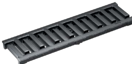
Grille passerelle, MASSIV 32, fonte GJS, revêtement KTL Classes de charge: E600* , Longueur: 50 cm, SW 11 mm Convient seulement à KE-100.
