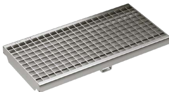
Grille à mailles, acier galvanisé, inox Classes de charge: D400* Longueur: 50 cm, 100 cm, MW 20 x 20 mm
