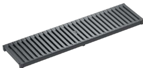
Grille passerelle, HEELGUARD, fonte laqué noir, fonte revêtement KTL Classes de charge: D400* , Longueur: 50 cm, SW 6 mm
