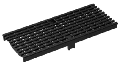
Grille à barres longitudinales, fonte GJS, revêtement KTL Classes de charge: E600* Longueur: 50 cm, MW 25 x 11 mm
