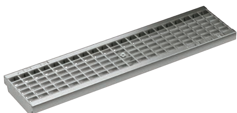
Grille à mailles, acier galvanisé, inox Classes de charge: B125, C250, D400 , Longueur: 50 cm, 100 cm MW 30 x 14 mm / 30 x 10 mm / 20 x 14 mm
