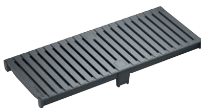
Grille passerelle, HEELGUARD, fonte GJS, laqué noir ou revêtement KTL Classes de charge: D400* Longueur: 50 cm, SW 6 mm
