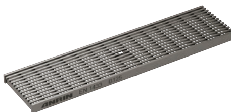
Grille à profil longitudinal, inox Classes de charge: B125, D400 , Longueur: 50 cm, 100 cm, SW 5 mm
