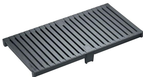
Grille passerelle, HEELGUARD, fonte GJS, revêtement KTL ou laqué noir Classes de charge: D400* Longueur: 50 cm, SW 6 mm
