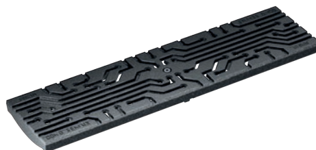
Grille en fonte, WIRE Design, fonte, revêtement KTL Classes de charge: D400* , Longueur: 50 cm, SW 5 mm
