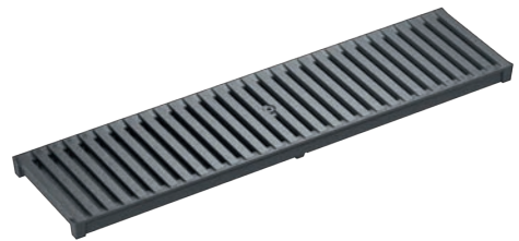
Stegrost, HEELGUARD, Gussseisen schwarz lackiert, Gussseisen KTL beschichtet Belastungsklasse: D400* , Länge: 50 cm, SW 6 mm
