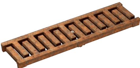
Stegrost, MASSIV 32, Gussseisen unbeschichtet, Belastungsklasse: E600* , Länge: 50 cm, SW 11 mm Nur für KE-100 geeignet.
