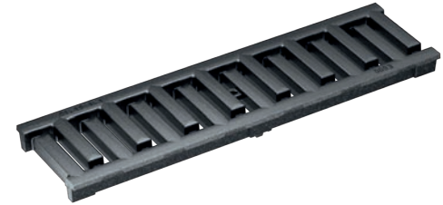
Stegrost, MASSIV 32, Gussseisen GJS, KTL- beschichtet Belastungsklasse: E600* , Länge: 50 cm, SW 11 mm Nur für KE-100 geeignet.
