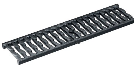
Stegrost, OvalGrip Design, Gusseisen, KTL beschichtet Belastungsklassen: C250, E600* , Länge: 50 cm, SW 10 mm Belastungsklasse: F900 nur für Rinne KF-100
