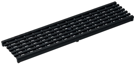
Längsstabrost, Gussseisen, KTL beschichtet Belastungsklasse: D400* , Länge: 50 cm, MW 25 x 10 mm
