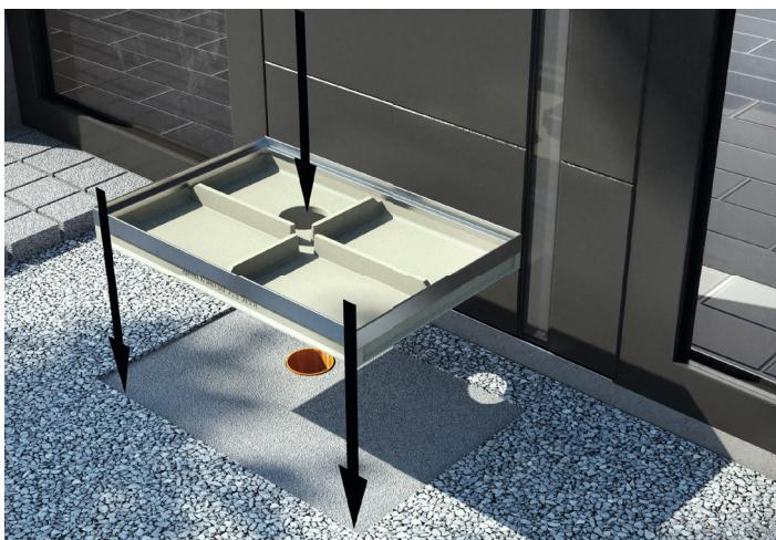
2. Schuhabstreifkasten auf das Splitt- oder Ortbetonbett aufsetzen. Ggf. Rohrleitung anschließen und höhengerecht ausrichten
