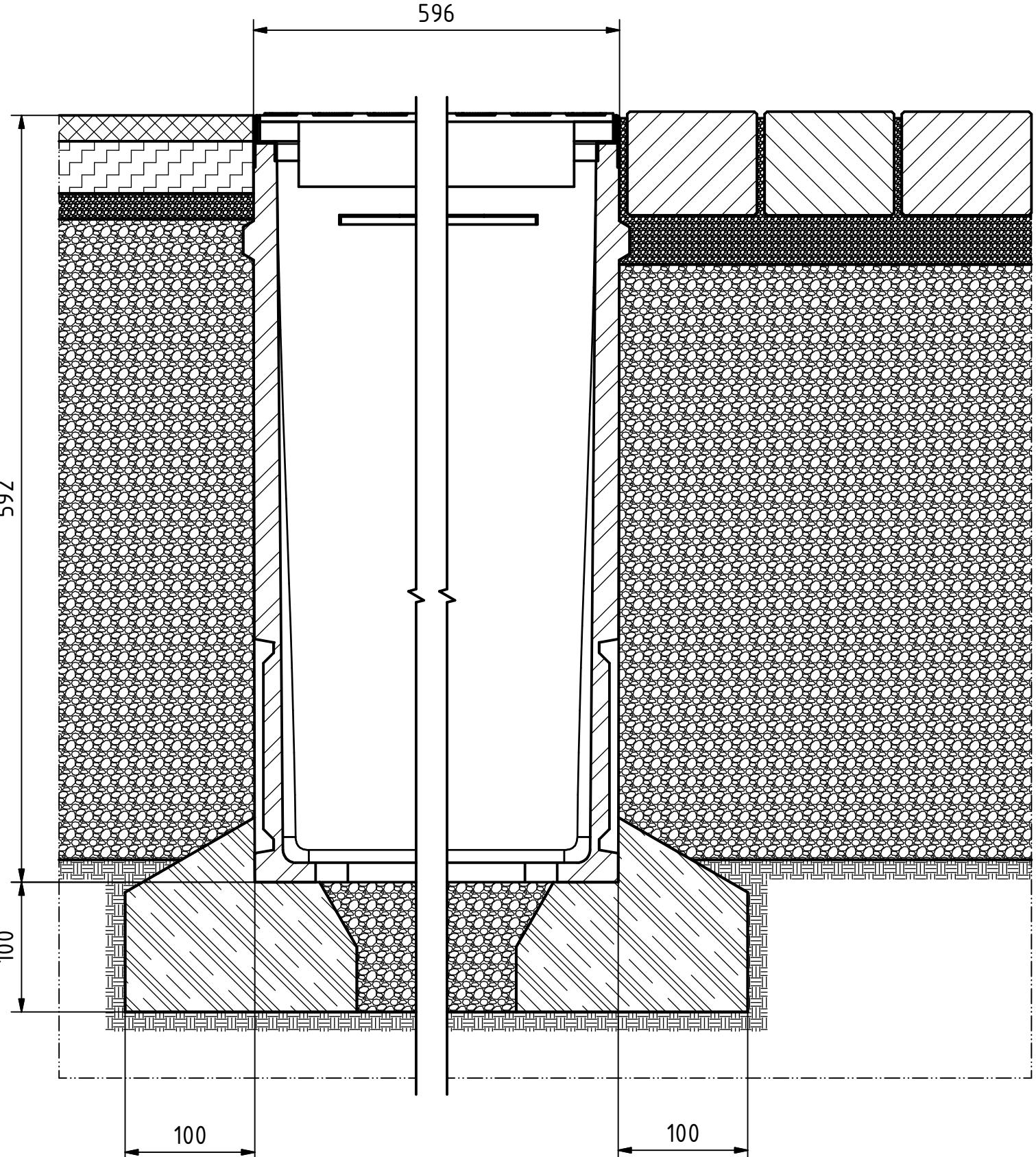
aus Polymerbeton, mit Stahlrahmen
