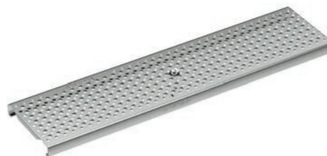
Grille à trous, acier galvanisé, inox Classes de charge: A15, C250 , Longueur: 50 cm, 100 cm, Ø 6 mm
