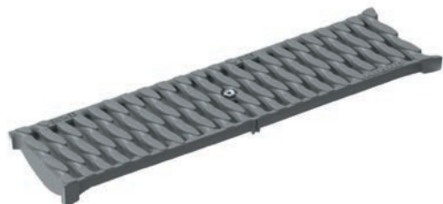
Grille passerelle, Design OvalGrip, plastique, gris Classes de charge: B125, C250 , Longueur: 50 cm, SW 8 mm
