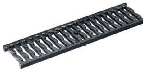
Grille passerelle, Design OvalGrip, fonte, revêtement KTL Classes de charge: C250, E600* , Longueur: 50 cm, SW 10 mm
