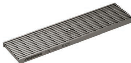
Grille à profil longitudinal, inox Classes de charge: B125, D400 , Longueur: 50 cm, 100 cm, SW 5 mm
