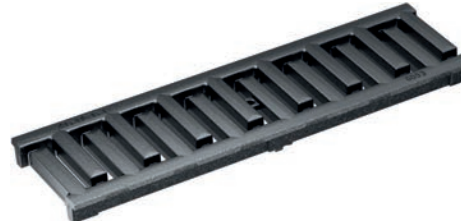
Grille passerelle, MASSIV 32, fonte GJS, revêtement KTL Classes de charge: E600* , Longueur: 50 cm, SW 11 mm Convient seulement à KE-100.
