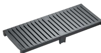
Stegrost, HEELGUARD, Guss GJS, schwarz lackiert oder KTL beschichtet Belastungsklasse: D400* Länge: 50 cm, SW 6 mm
