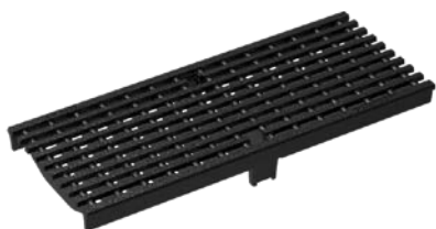
Längsstabrost, Guss GJS, KTL beschichtet Belastungsklasse: E600* Länge: 50 cm, MW 25 x 11 mm
