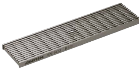
Längsprofilrost, Edelstahl Belastungsklassen: B125, D400 , Länge: 50 cm, 100 cm, SW 5 mm
