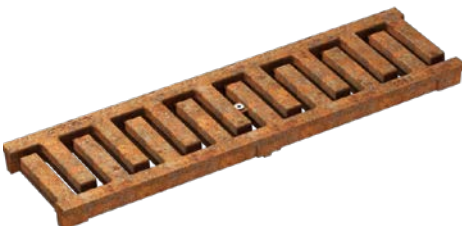
Stegrost, MASSIV 32, Gusseisen unbeschichtet, Belastungsklasse: E600* , Länge: 50 cm, SW 11 mm Nur für KE-100 geeignet.
