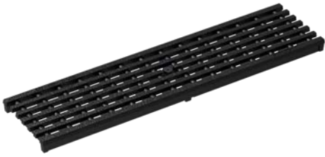
Längsstabrost, Gusseisen, KTL beschichtet Belastungsklasse: D400* , Länge: 50 cm, MW 25 x 10 mm
