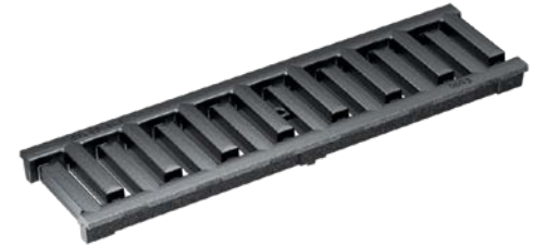
Stegrost, MASSIV 32, Gusseisen GJS, KTL- beschichtet Belastungsklasse: E600* , Länge: 50 cm, SW 11 mm Nur für KE-100 geeignet.
