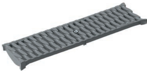
Stegrost, OvalGrip Design, Kunststoff, Grau Belastungsklasse: B125 und C250 , Länge: 50 cm, SW 8 mm
