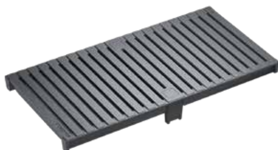
Stegrost, HEELGUARD, Guss GJS, schwarz lackiert oder KTL beschichtet Belastungsklassen: D400* Länge: 50 cm, SW 6 mm
