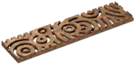
Designrost, CELTIC, Gusseisen unbeschichtet Belastungsklasse: C250 , Länge: 50 cm, SW 10 mm
